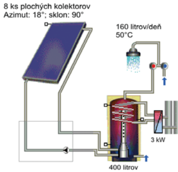
T*SOL Schéma hydraulického zariadenia (vlastný výpočet)
